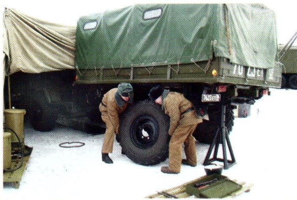
Замена поврежденного колеса
